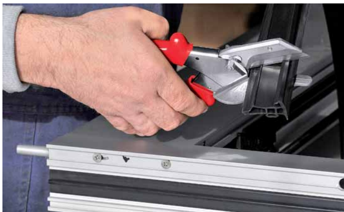
Auslinken und spanbrechen in einem Arbeitsgang
