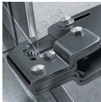
Das Stempelwerkzeug wird durch die Profilbleche gedrückt
