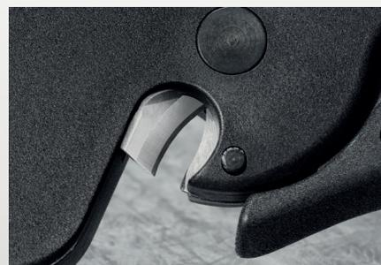
Mit Kabelschneide für Leiter bis 10 mm<sup>2</sup>.
