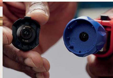
Für den schnellen Wechsel befindet sich ein Ersatzschneidrad im blauen Drehknauf.
