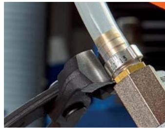
10 98 I220: Abdichten Schlauchanschluss an Zentralschmierung
