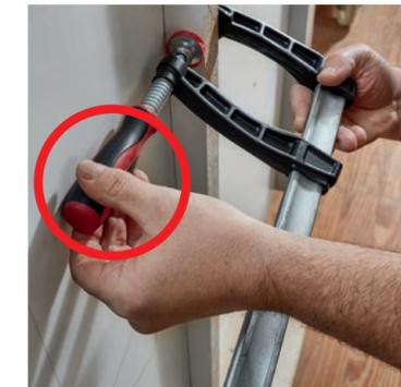
Das Spannen vor einer geschlossenen Fläche ist durch die Positionierung des Griffs bei klassischen Schraub- und Hebelzwingen nicht möglich, da der Griff nicht betätigt werden kann.
