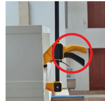
Das Risiko einer Beschädigung des Werkstücks und einer Verletzung erhöht sich in beengten Arbeitsbereichen, wenn Spannwerkzeuge mit überstehenden Bauteilen eingesetzt werden.
